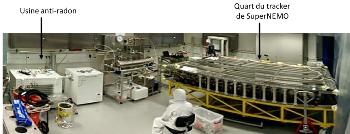
Figure 94 : Photographie de l'usine anti-radon installée à l'UCL reliée au tracker de SuperNEMO pour des tests d'émanation
