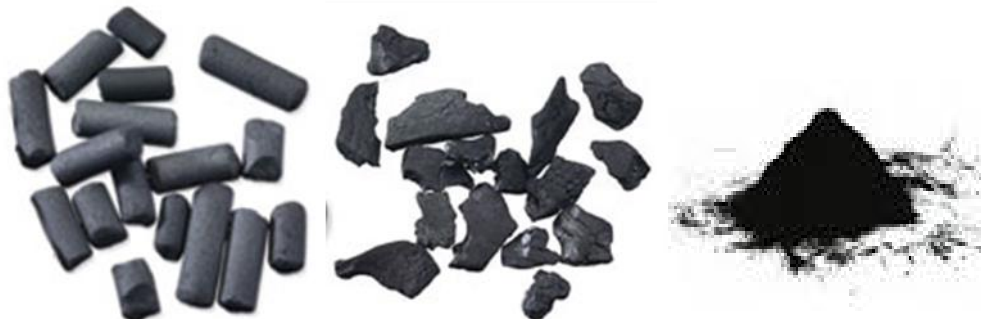
Figure 40 : Charbons actifs, de gauche à droite, en granulé, en morceau, et en poudre
