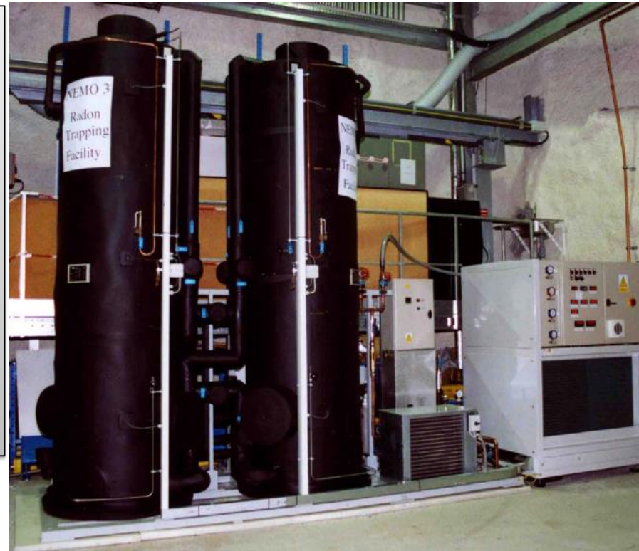
Figure 10 : À gauche schéma du système anti-radon utilisé pour purifier l'air autour de NEMO 3, à droite photo de l'usine anti-radon
