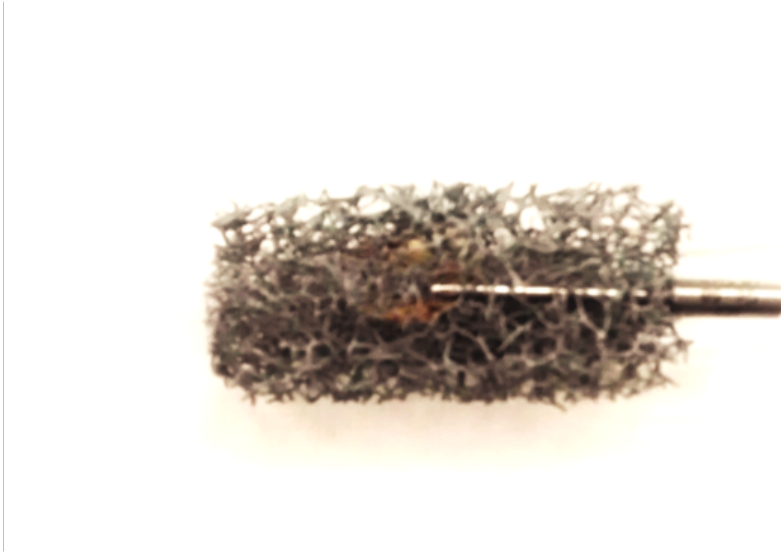
Figure 3.69 Photographie de l'éponge végétale recouverte de peinture métallique dans laquelle sont insérées deux sources ponctuelles: ^{68}\text{Ge} et ^{22}\text{Na} .
