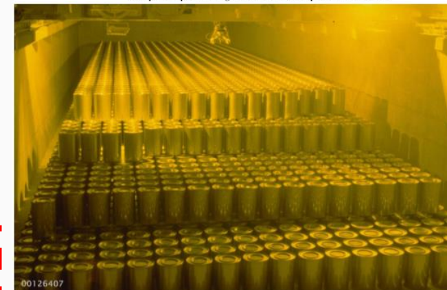
exemple d'empilement de galettes de déchets compactés dans un CSD-C
