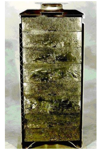
exemple d'empilement de galettes de déchets compactés dans un CSD-C
