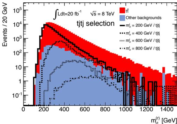
FIGURE 1.3 – Spectre de masse reconstruite des sgluons dans la topologie  $ttjtj$  par l'algorithme du  $\chi^2$ . Les surfaces pleines correspondent aux bruits de fond physique et les lignes au signal pour différents points de masse.
