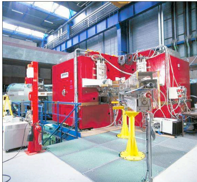
Figure 24 : Dans notre étude les ions sont accélérés par un cyclotron (CIME).
