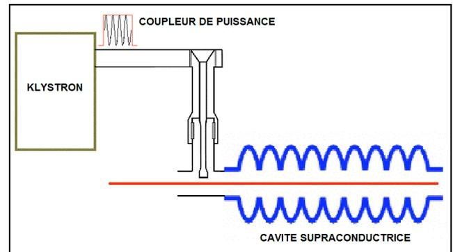
Figure (1) : Position du coupleur dans la chaîne de puissance.
