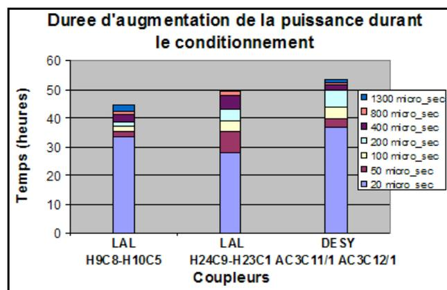
Figure (5) : Comparaison des temps de conditionnement de différentes paires de coupleurs [8],[9].
