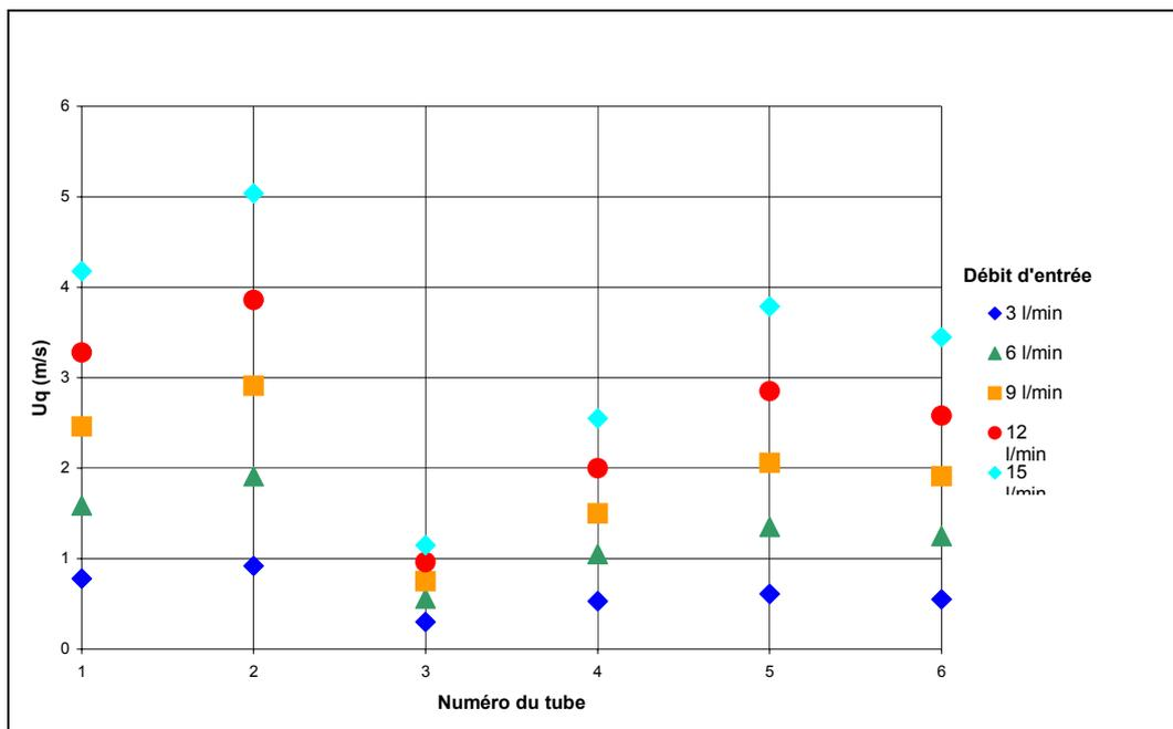
Fig. 16 Evolution des vitesses dans chaque tube en fonction du débit d'entrée d'après [4].
