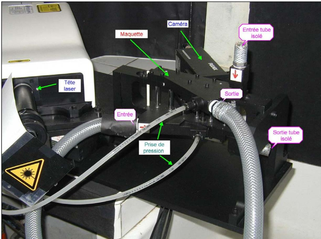
Fig. 11 Maquette montée sur le banc expérimental.
