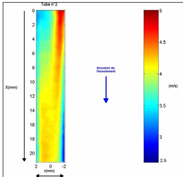
Fig. 34 Composante x des vitesses mesurées dans le tube n°2.
