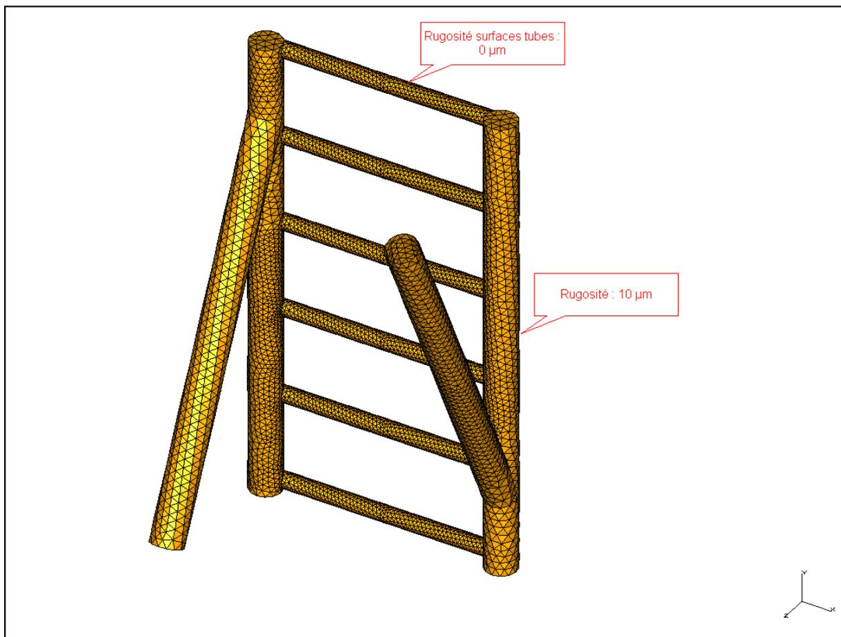
Fig. 22 : Surfaces d'écoulement avec leurs rugosités.
