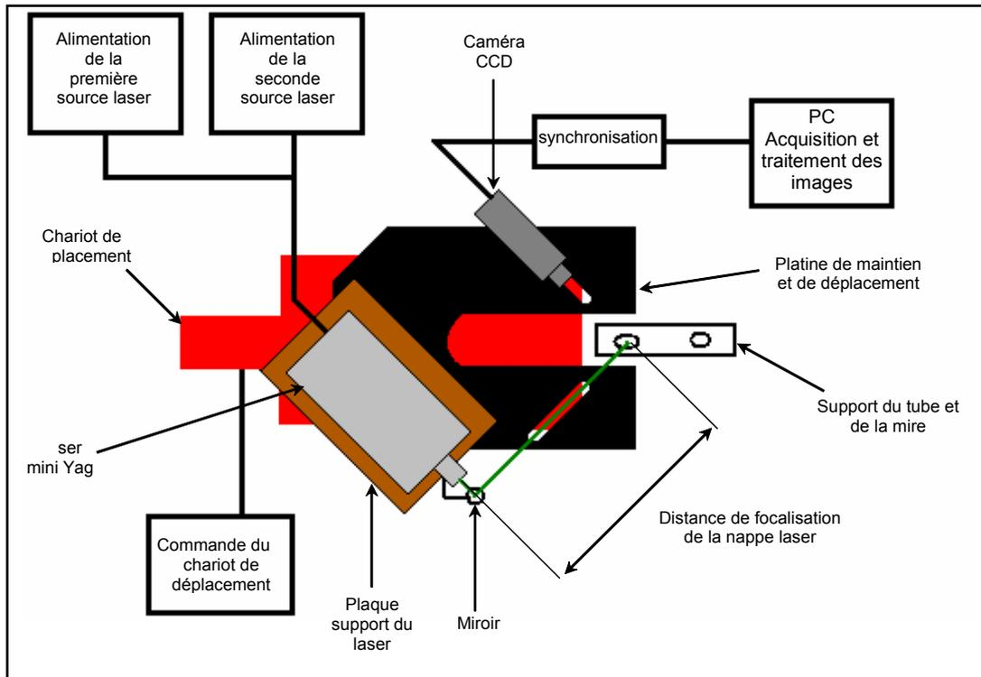
Fig. 7 Chaîne de mesure PIV d'après [1].
