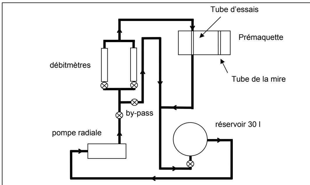
Fig. 4 Schéma du banc hydraulique d'après [1].
