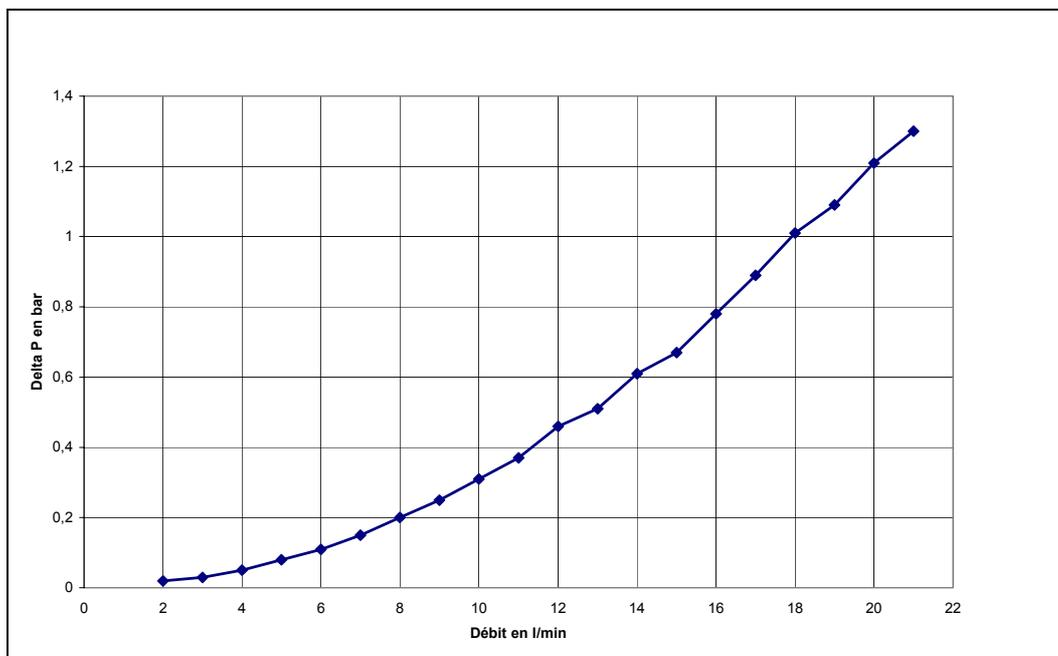
Fig. 13 Perte de charge entre l'entrée et la sortie de la maquette d'après [3].
