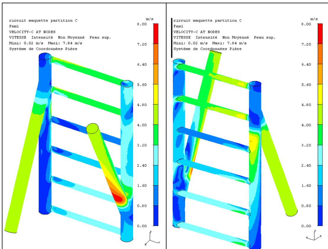
Fig. 25 Modèle D : Vitesses pour un débit d'entrée de 12 l/min.
