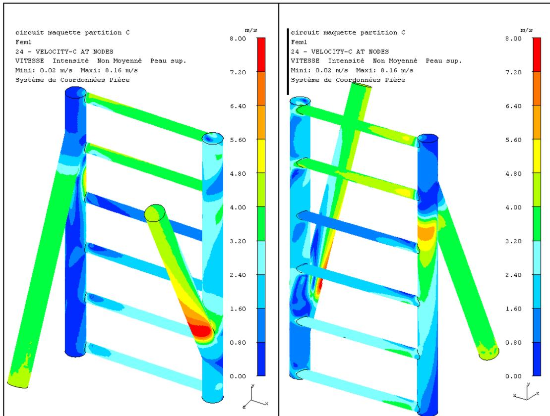
Fig. 24 Modèle C : Vitesses pour un débit d'entrée de 12 l/min.
