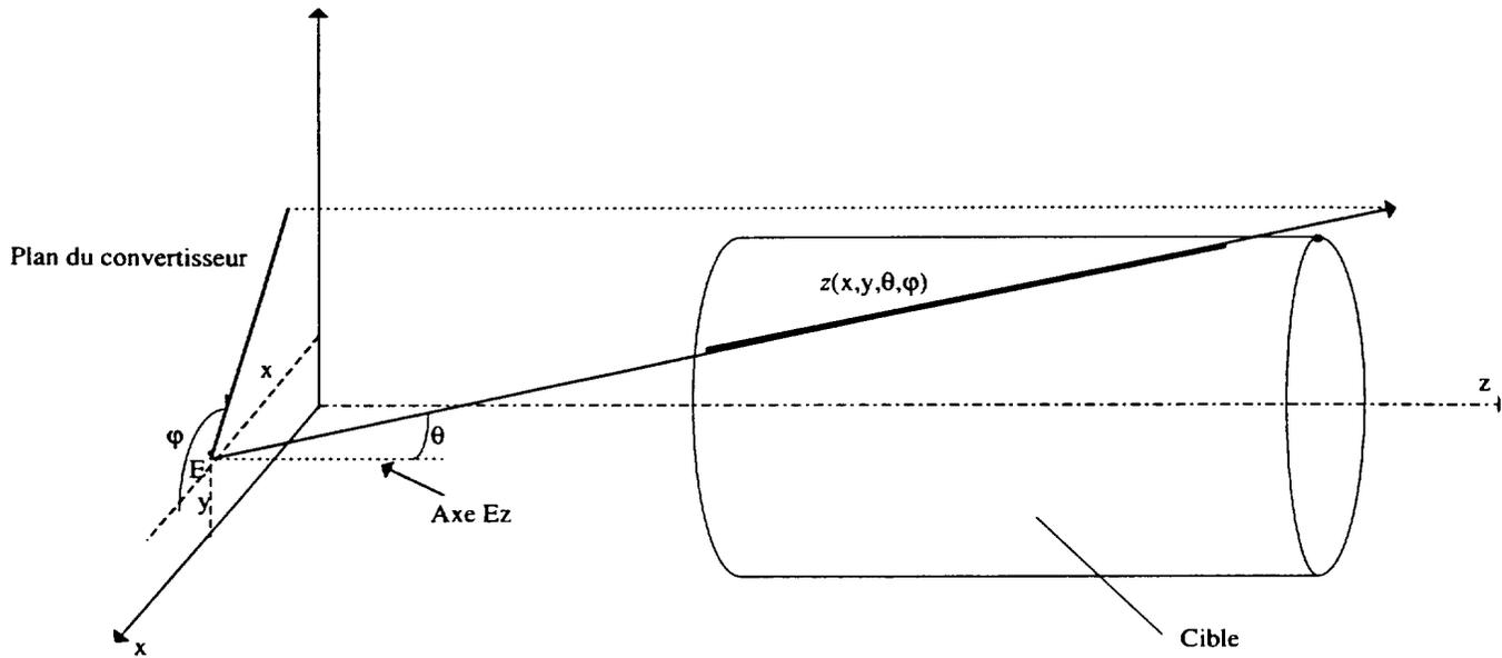
La longueur moyenne  $z_m$  du parcours d'un neutron émis d'un point du convertisseur E de coordonnées  $(x, y)$  est donné par la relation :
