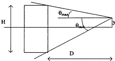
Pour chaque valeur de  $x$ , on peut calculer l'angle  $\psi_0$  dans le plan caractérisé par  $y = constante$  entre les droites tangentes extérieures au cylindre et la droite qui passe dans l'axe de symétrie du cylindre cible:
