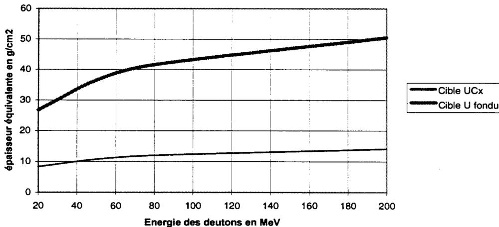
**Conclusion :** la cible d'uranium fondu contenue dans un creuset vertical présente l'inconvénient de ne pas être orientée dans le sens du faisceau. Cependant, compte tenu de sa plus forte densité en uranium, elle aura une épaisseur équivalente 3 à 4 fois plus grande que celle du carbure d'uranium.
