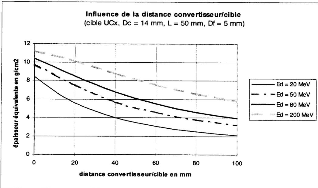
**conclusion :** nous voyons l'intérêt de placer le convertisseur aussi près que possible de la cible : en effet avec un convertisseur au contact de la cible, on gagnera un facteur 2 à 4 par rapport à un convertisseur situé à 10 cm de la cible.
