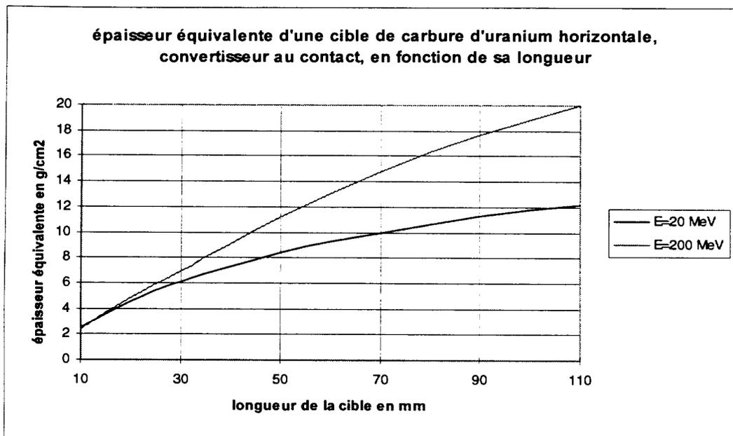
**Conclusion :** pour les faibles énergies, il n'est pas forcément nécessaire de prévoir une cible très longue. En effet, avec un faisceau de 20 MeV une cible de 100 mm donnera un résultat supérieur de seulement 40 % à celui d'une cible de 50 mm. Ce paramètre est donc secondaire par rapport à la distance convertisseur/cible.
