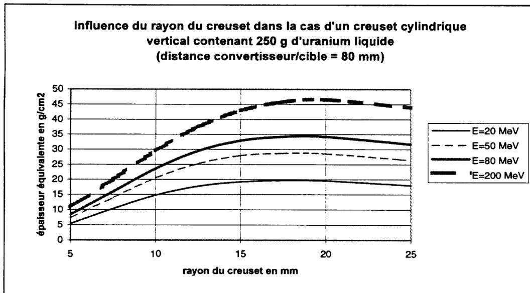
**Conclusion :** ces courbes nous montrent la valeur optimum pour chaque énergie. Si le matériau utilisé pour la fabrication du creuset nous le permet on choisira un creuset de rayon 15 mm commun aux différentes énergies. En effet, il sera proche de l'optimum tout en étant compatible avec les contraintes liées au système de chauffage. A noter que dans le cas de l'uranium fondu, un grand diamètre du creuset permettra une sortie plus rapide des éléments produits.
