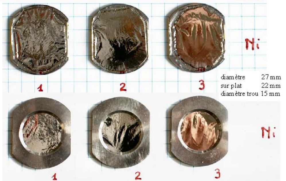
Ci-dessus les cristaux de Nickel, épaisseur 2µm, au déballage. En-dessous les mêmes cristaux retendus. 24/10/02 R.K. IPN Lyon
