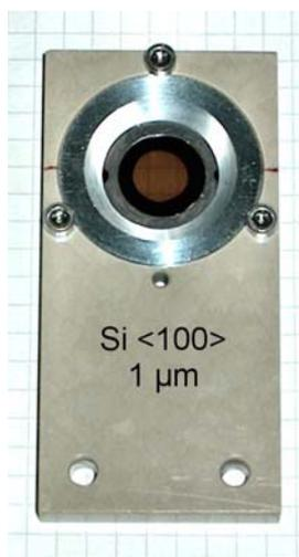
A droite, la face d'entrée du faisceau (à 45° de la normale du côté de la flèche)
