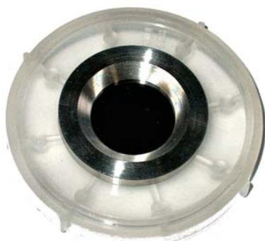
A droite, la face d'entrée du faisceau (à  $35,5^\circ$  de la normale du coté de la flèche)
